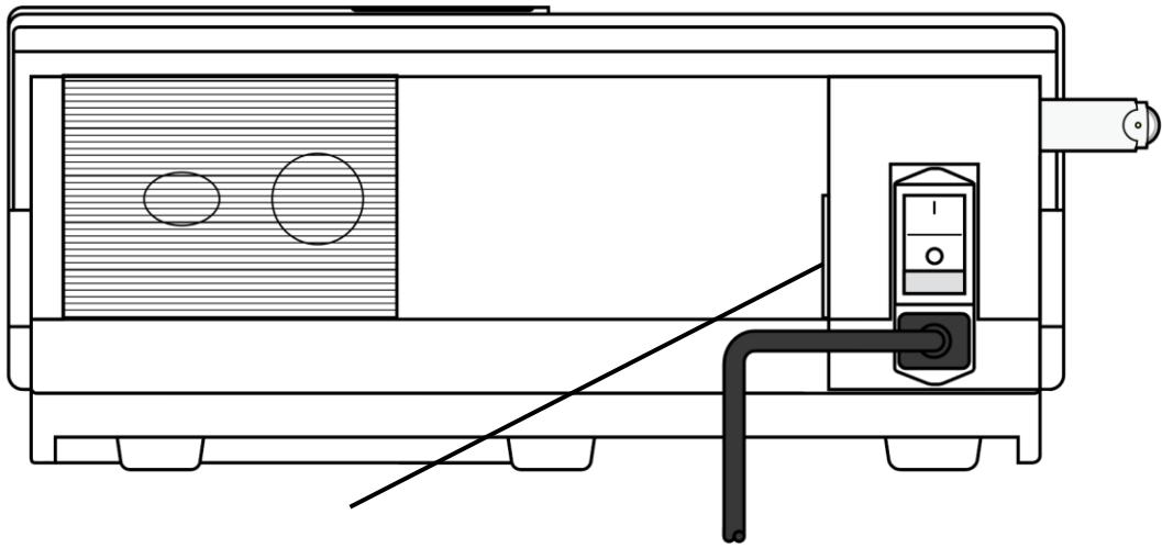
**Port RS-232 (connexion au modem)**
