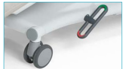
Große Laufrollen Ø 10 cm, Zentral-Arretierung inkl. Untergestell-Vollverkleidung
