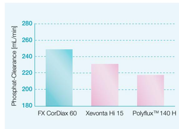
Wässrige in-vitro Phosphat-Clearance ( $Q_B = 300$  mL/min,  $Q_D = 500$  mL/min). Vergleichsuntersuchung durch EXcorLab GmbH (akkreditiertes Prüf- und Forschungsinstitut).
