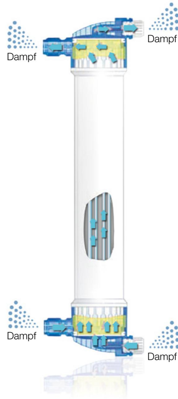
Integritätstestung mit steriler Luft und sterilem Wasser. Jeder bei Fresenius Medical Care INLINE dampfsterilisierte Dialysator durchläuft diesen Test, so dass eine 100% Kontrolle durchgeführt wird.
