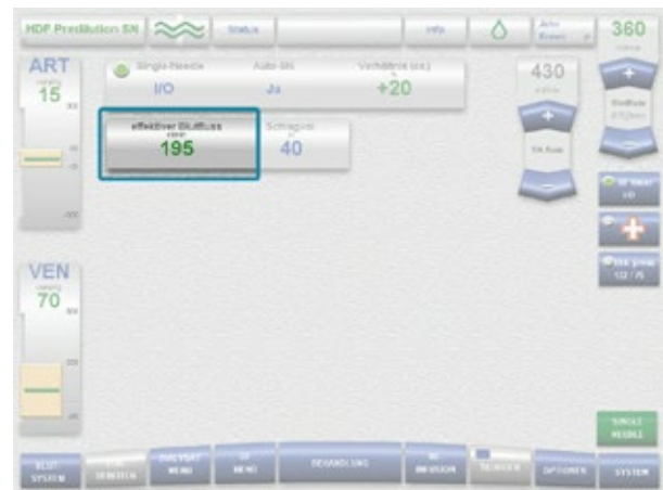
Abbildung 3: Effektiver Blutfluss im Single-Needle-Modus
