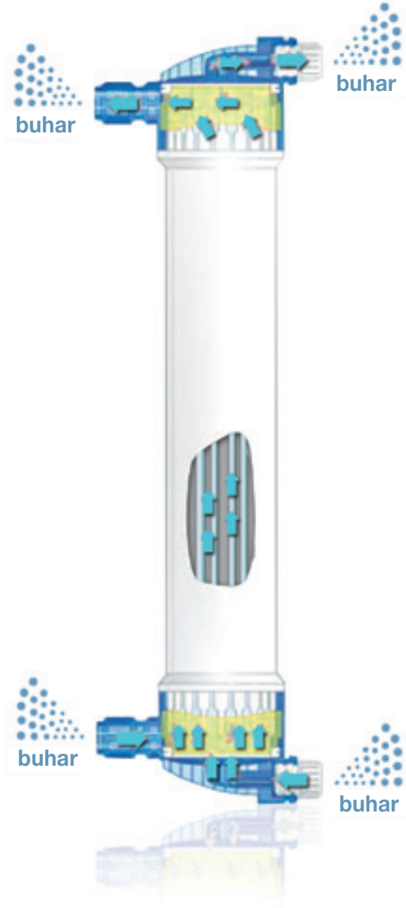
INLINE buhar sterilizasyon işlemi ve bütünlük testi.
